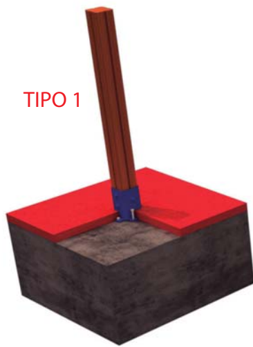
FIJACION A SOLERA DE HORMIGON
